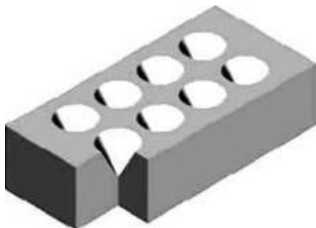
Рисунок А.3 - Изделие с несквозными пустотами
